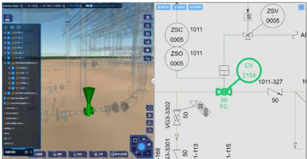
图 2 数字化交付二三维同步和分屏联动
